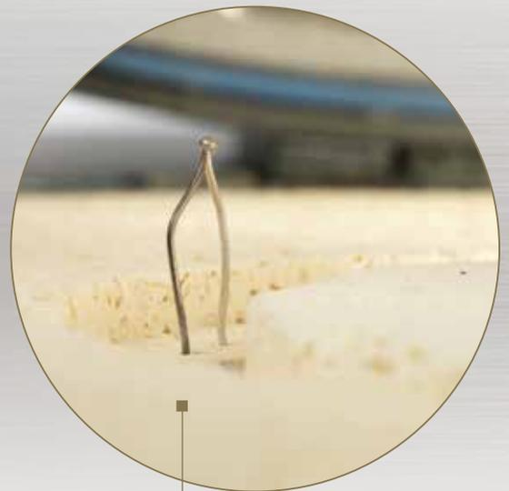
Platin-Thermoelement zum Bestimmen der Brenntemperatur
